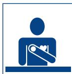
5. Pri použíti prístroja na meranie tlaku na zápästí držte manžetu počas merania v úrovni srdca. U prístroja na meranie tlaku na ramene sa manžeta automaticky nachádza v správnej výške.
